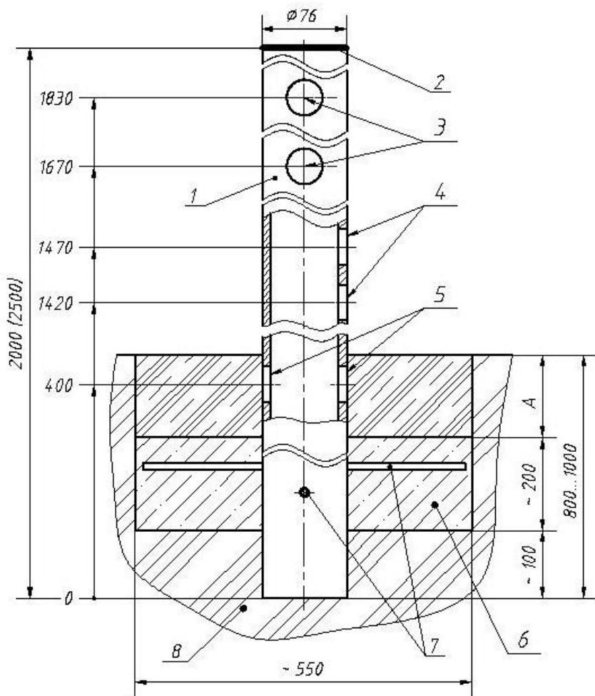
1- Стойка «ОПОРА-2» или «ОПОРА-2,5»; 2- заглушка пластмассовая; 3- отверстия для ввода кабеля извещателя внутрь опоры; 4- отверстия для ввода магистрального кабеля и кабеля извещателя; 5- отверстия для ввода магистрального кабеля; 6- бетон (гравий); 7- штыри для предотвращения несанкционированного демонтажа опоры; 8- грунт.
