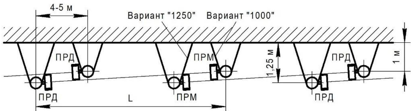
Рисунок 2.5 - Пример установки извещателей «ФОРТЕЗА-М» (общего назначения) на «Кронштейне-1000/1250» с перекрытием зон обнаружения
