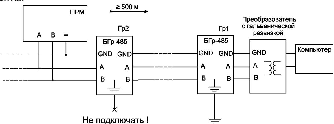
Рисунок 2.12 - Пример обеспечения грозозащиты линии RS-485
