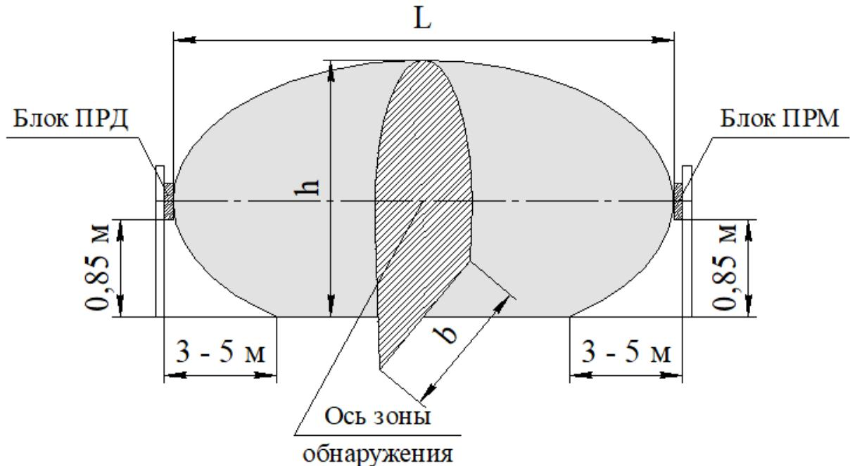
Рисунок 1.1 – Конфигурация зоны обнаружения, формируемой извещателями, установленными на опорах
