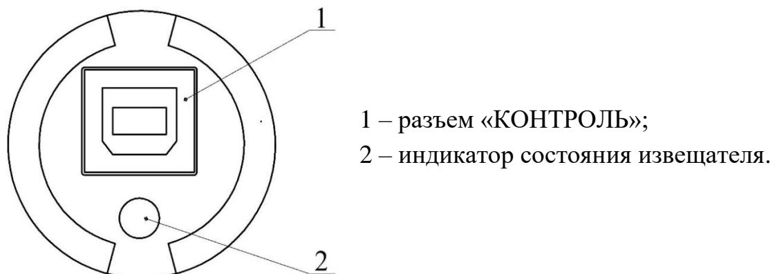
Рисунок 1.4 - Органы настройки блока ПРМ извещателей «ФОРТЕЗА-М» (общего назначения)
