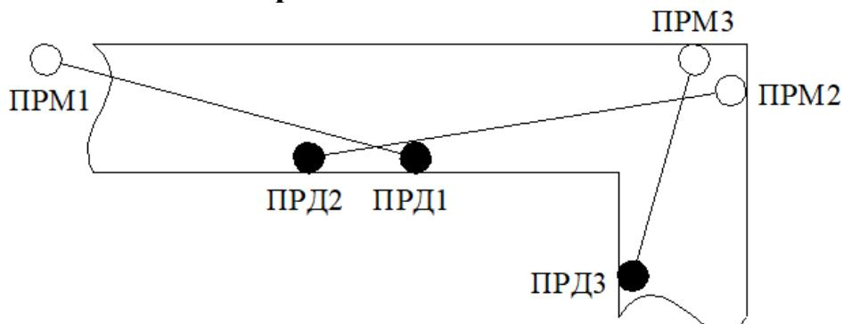
Рисунок 2.1 – Пример разметки периметра для установки извещателей
