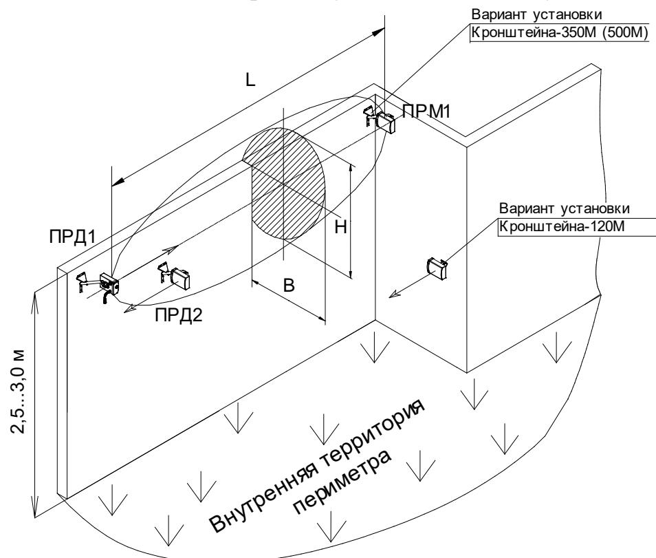
Рисунок 2.8 - Пример установки извещателя с применением выносных кронштейнов 500М, 350М, 120М
