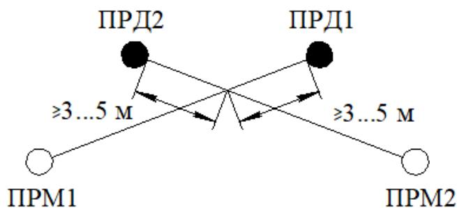
Рисунок 2.2 – Пример разметки периметра для установки извещателей
